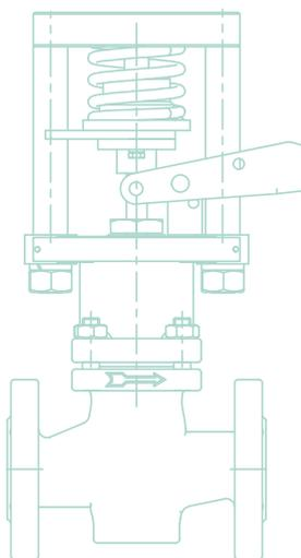
Vannes de régulation sont utilisées pour contrôler température, pression et niveau et sont donc considérées comme composants vitaux d'une installation. La choix correcte a un grand effet sur la stabilité et puissance de l'installation et augmente la qualité du processus. Sodeco Valves peut offrir:
